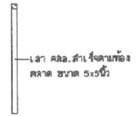
5 งานติดตั้งเสา คสล. แทนเสาที่ชำรุด และซ่อมผนังวงรีค้ำที่ชำรุด
